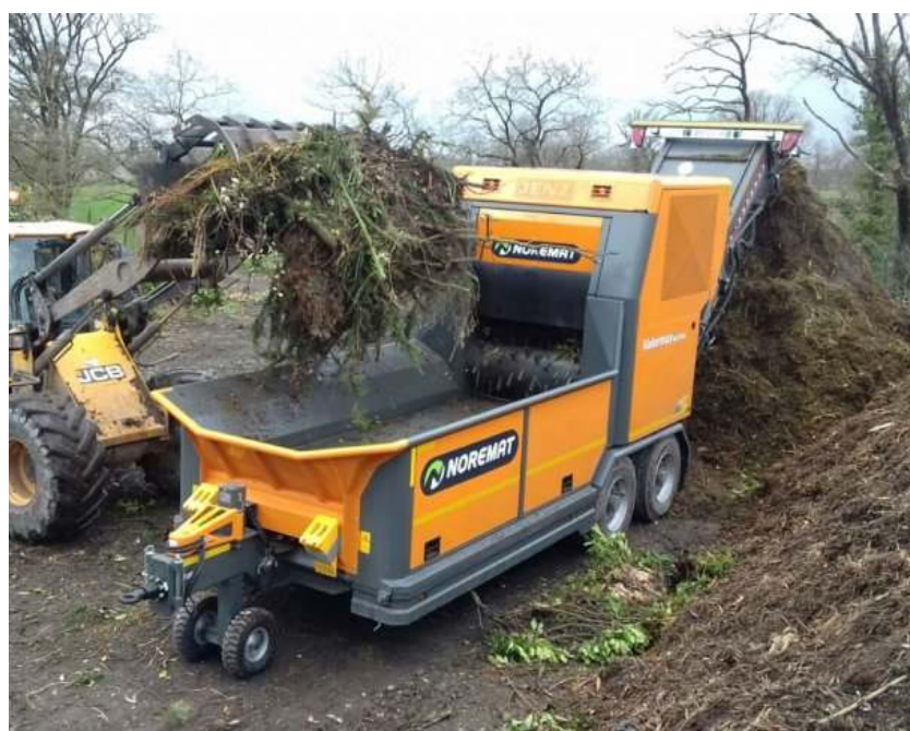
Broyage rapide de déchets verts pour la méthanisation, photo NOREMAT
