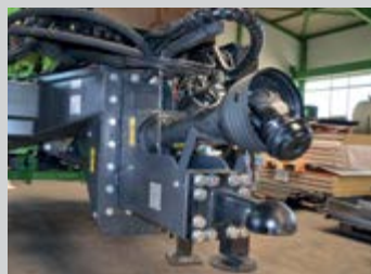
Hauteur d'attelage ajustable 500, 600, 900 ou 1000 mm
