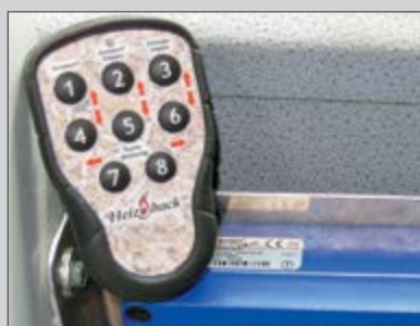
Télécommande radiocommandé pilotage de la goulotte d'éjection
