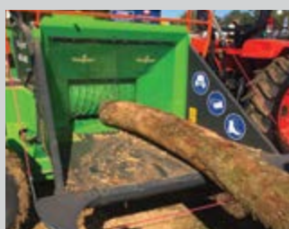
Système d'alimentation puissant : rouleau Ø 400 mm et tapis ameneur en acier à dents d'entraînement soudées.
