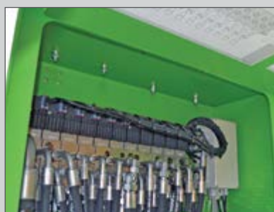
Bloc hydraulique avec levier pour fonctionnement manuel
