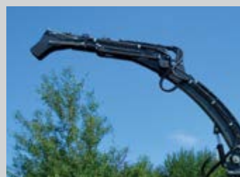
Goulotte télescopique électrique avec caméra (en option)
