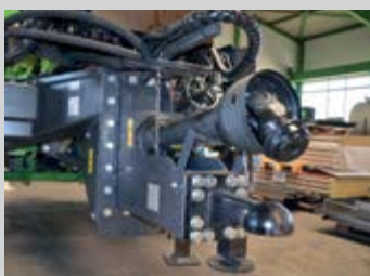
Hauteur d'attelage ajustable 500, 600, 900 ou 1000 mm
