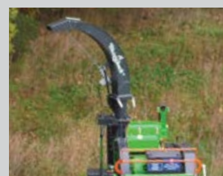
Tourelle et casquette hydro-electrique orientable et ajustable de série
