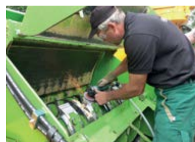
Rotor à couteaux à changement rapide et affûtage facile à poste.
