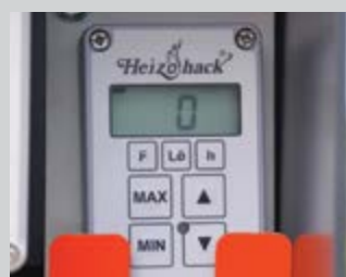
Système de commande no-stress Heizohack HE 002 pour réguler l'avancée du bois en fonction de la puissance d'entraînement.
