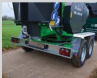
Châssis routier 80 km/h + barre de protection
