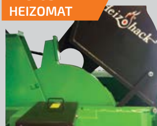
Soufflerie à volant d'inertie de 470 kg : éjection des plaquettes puissante + réserve de puissance.
