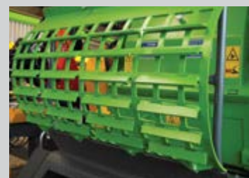
Grille avec déflecteurs : 45/60 mm, 60/80 mm, 80/80 mm
