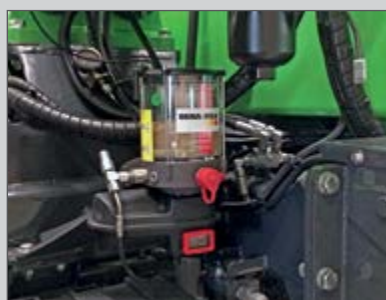
Lubrification automatique centralisée facile et rapide d'utilisation
