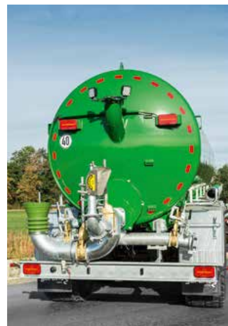
Cône de ravitaillement pour véhicule de transport (TAV) sur la partie inférieure de la paroi arrière de la cuve
