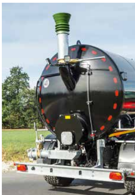
Cône de ravitaillement pour véhicule de transport (TAV) sur la partie supérieure de la paroi arrière de la cuve
