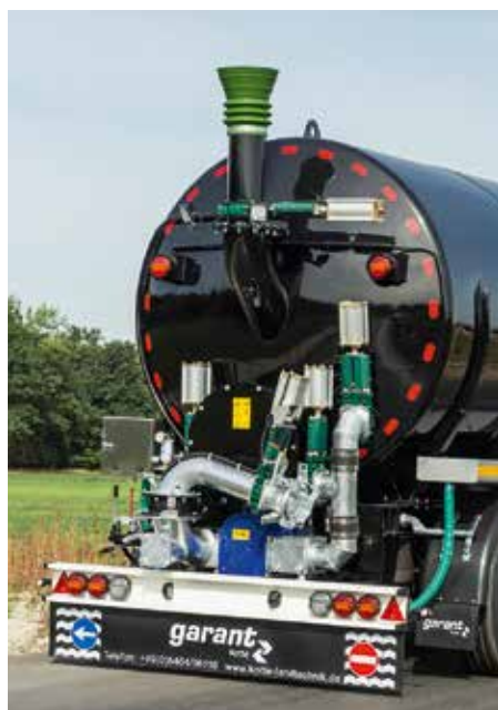
Cône de ravitaillement pour véhicule de transport (TSA) sur la partie supérieure de la paroi arrière de la cuve
